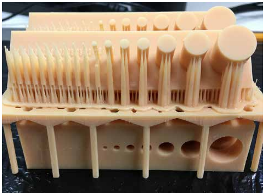
Kuva 2. Asigan MAX UV tulostimella tulostettuja testikappaleita ennen tukien poistamista
