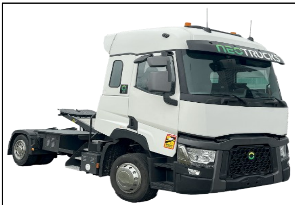
Kuva 7: Terminaalitraktori (Neotrucks.fr). Raskaan kaluston konvertoinnilla on erityisesti mahdollisuuksia erikoiskauston kohdalla.
