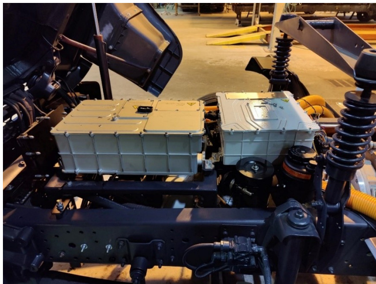
Kuva 11 Kuva 12 Tehoelektroniikan asennuskehikko autossa. Kuva: Jukka Pellinen
