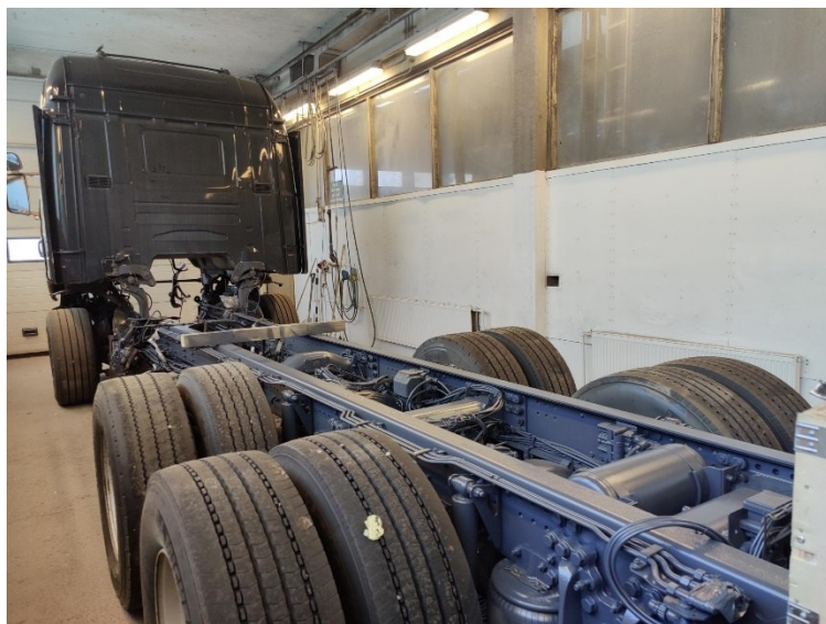
Kuva 10 Käytetty konversioauto dieselvoimalinjan purun ja maalauksen jälkeen valmiina sähkövoimalinjan asennukseen. Kuva: Jukka Pellinen
