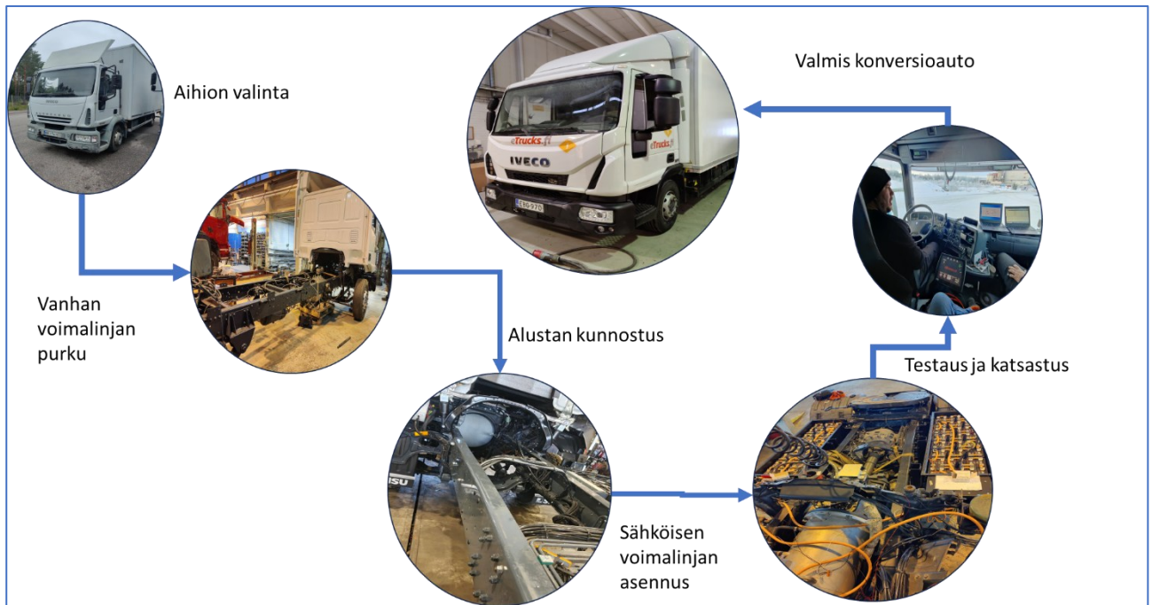
Kuva 9 Konversioprosessin vaiheet. Kuvat: Jukka Pellinen
