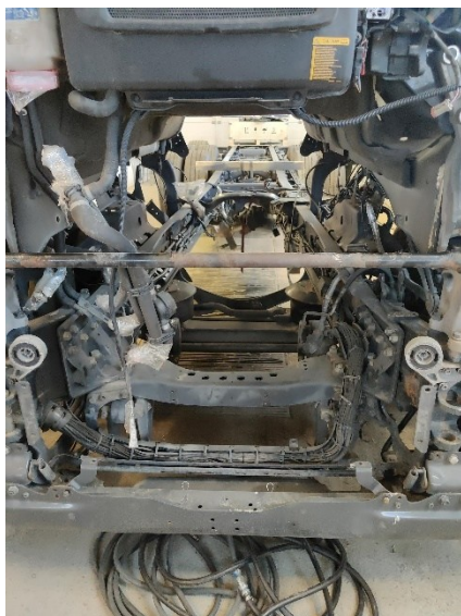
Kuva 10 Käytetty konversioauto dieselvoimalinjan purun ja maalauksen jälkeen valmiina sähkövoimalinjan asennukseen. Kuva: Jukka Pellinen
