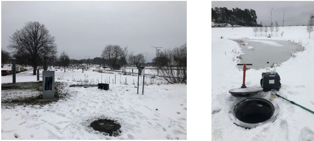
Kuva 8. Esimerkkejä näytteenottopaikoista ja hulevesinäytteenotossa käytetyistä laitteista.
