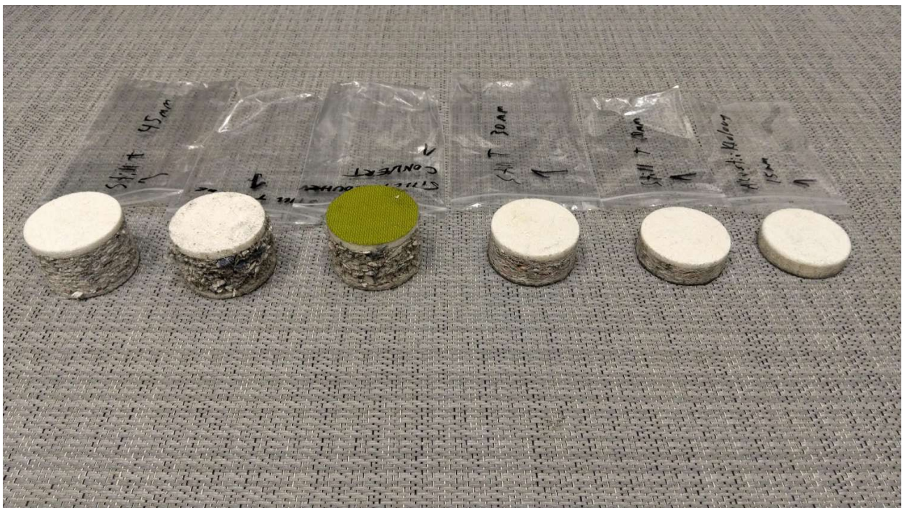
Kuva L2.1 Mittaussarjan 1 näytteet vasemmalta lukien: Still T 45 mm, Still T Rouhe 45 mm LV, Still T Rouhe 45 mm Convert 2000, Still T 30 mm, Still T 20 mm ja akustiikkalevy 15 mm.
