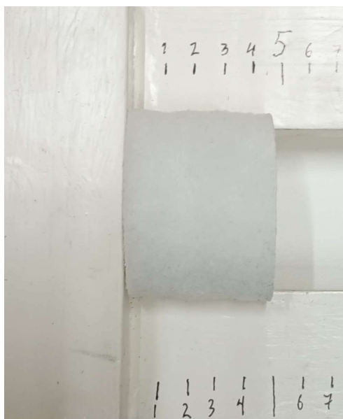
Kuva L2.1 Näyte 1, kokonaispaksuus 47.2 mm.
