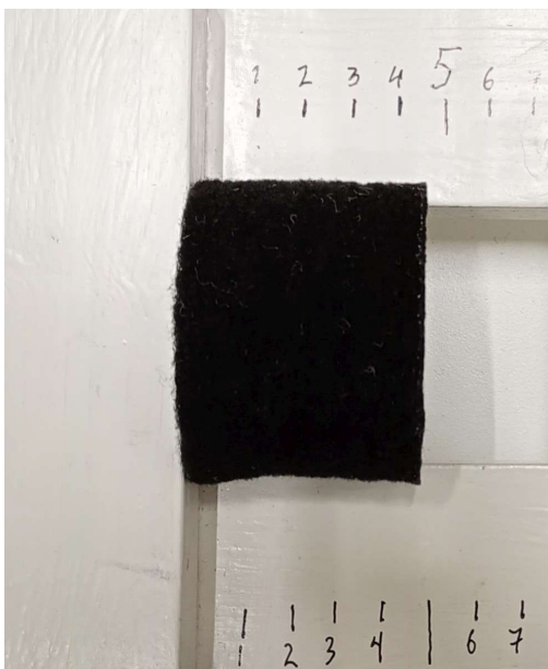
Kuva L2.4 Näyte 4, kokonaispaksuus 47.1 mm.
