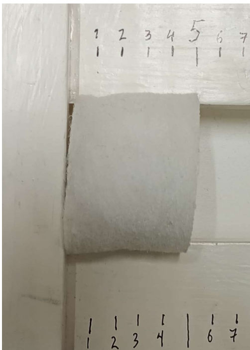
Kuva L2.3 Näyte 3, kokonaispaksuus 47.4 mm.
