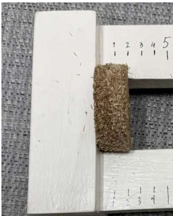
Kuva L2.3 Näyte 3, kokonaispaksuus 22.2 mm.
