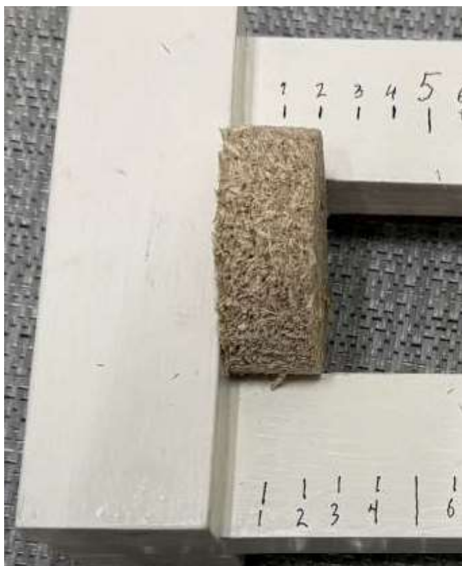
Kuva L2.1 Näyte 1, kokonaispaksuus 24.4 mm.
