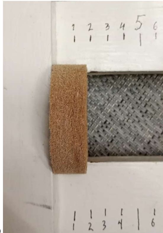
a) Kuva L2.2 a) Näyte 220525-003, kokonaispaksuus 19 mm, b) Näyte 230525-002, kokonaispaksuus 18 mm.
